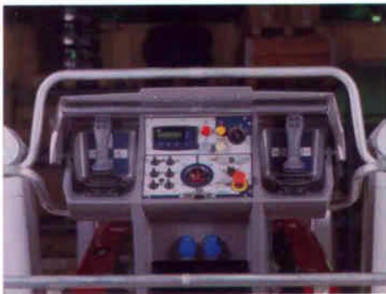
Alle Fahr- und Auslegerfunktionen werden von dem gut konzipierten Bedienpult aus gesteuert.
