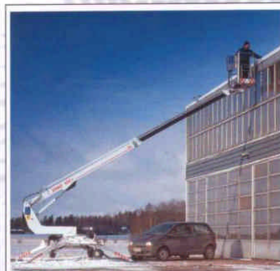
Die neue stabile Konstruktion erlaubt eine maximale seitliche Reichweite bis 8,3 m.
